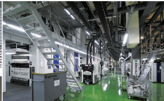
紫外線吸収膜付ランプ初期照度補正付直付器具による高速輪転機周りの照明
