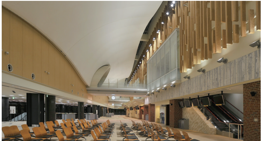
「雲の広場」の照明 壁面上部と壁面中部に設置した145Wネオセラ小形投光器により開放感あふれた明るい空間を演出
