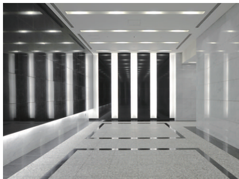
オフィス棟エントランスの照明 昼白色の光色による壁面の間接照明でインパクトのある光環境を演出
