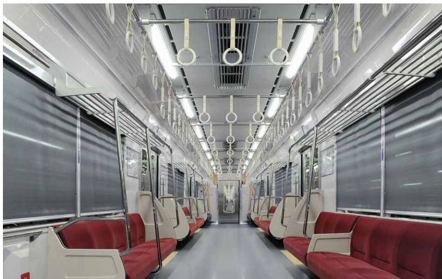
天井左右に特注LEDベースライトをライン状に配置し、快適な客室照明が得られている新1000形の新造車両
