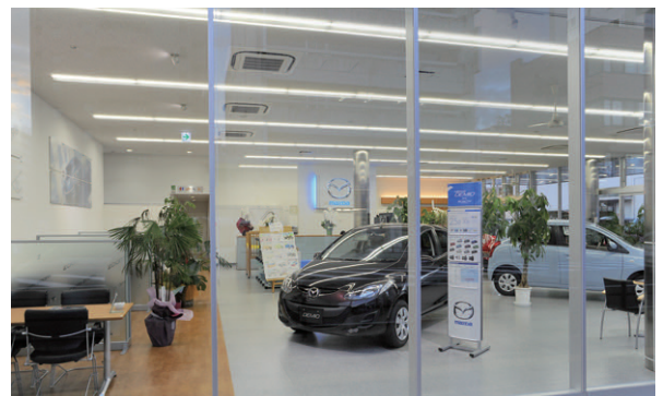
LED照明で内部空間を明るくしたことでガラスファサードへの映り込みを抑制し見通しのよい内部を形成
