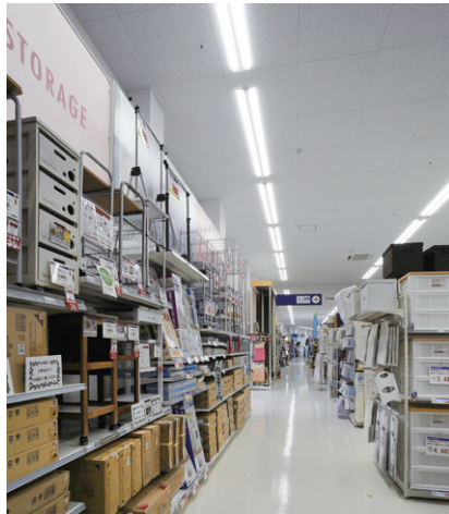
壁面展示商品を際立たせるよう壁と平行にLED照明をライン配置
