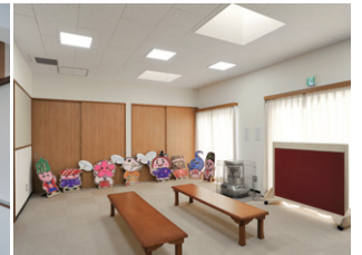
集会室にはHfコンパクト形蛍光灯埋込スクエア器具下面乳白カバー付を採用
