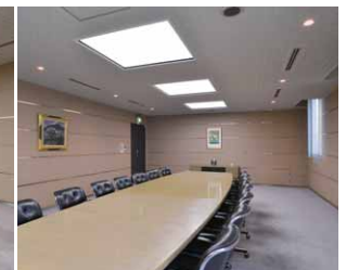
ランプのみを直管形LEDランプ40タイプに更新した1階応接室(左)、1階会議室(右)
