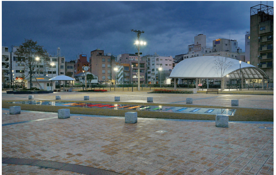
「まちかど広場」の照明 平面噴水を囲む形でLED地中埋込器具を配置。右奥が屋根付シェルター、左奥が開放的な芝生広場の夜景
