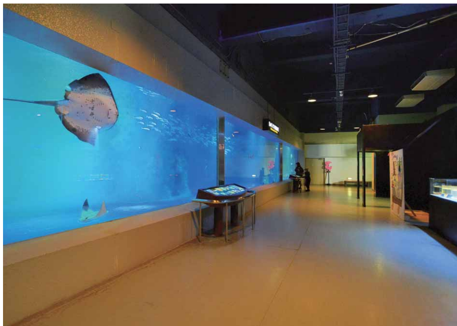
「海のパノラマ回遊水槽」のLED照明 LED投光器を斜め上から昼光風に演出。上部からはブルーのLED光で青い海を演出
