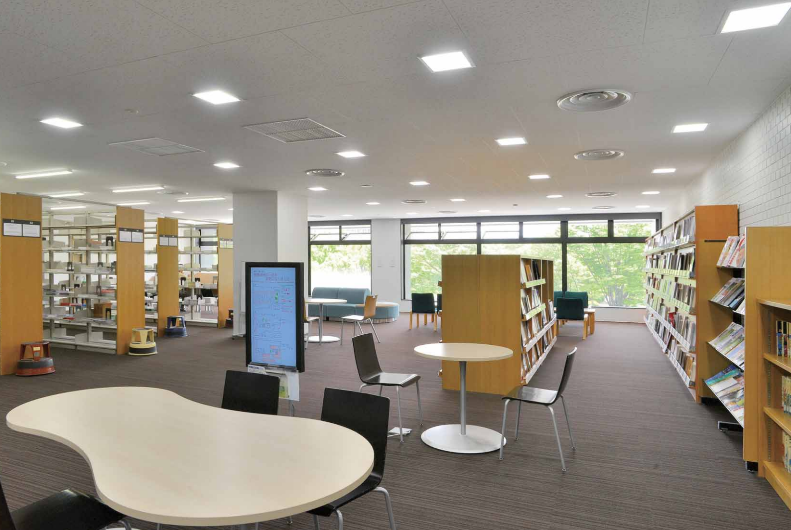
3階の新着雑誌などを閲覧できるブラウジングルームの開放感あふれる一体形LEDベースライト埋込形スクエアによる照明
