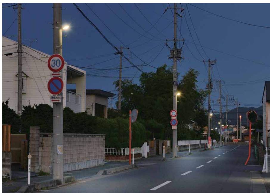
既存の20W形蛍光灯及び40W形水銀ランプから更新されたLED防犯灯
