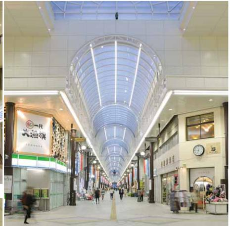
店先の屋根にLEDダウンライト、天井エッジにLEDライン器具、アーケード屋根にLEDライン器具を設置
