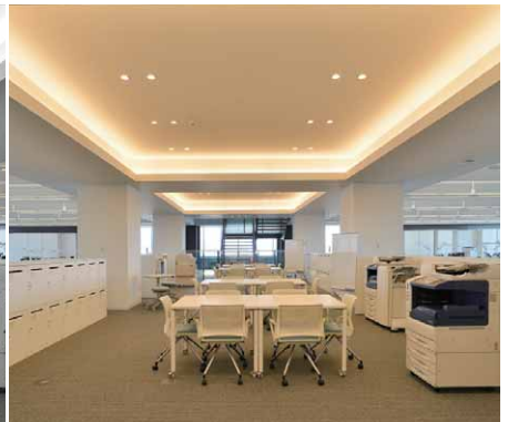
色温度が自動的に切り替わった簡易打ち合わせスペース。3000K時
