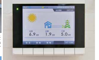
廊下に設置され、電力の使用状況や発電状況を表示する液晶モニター
