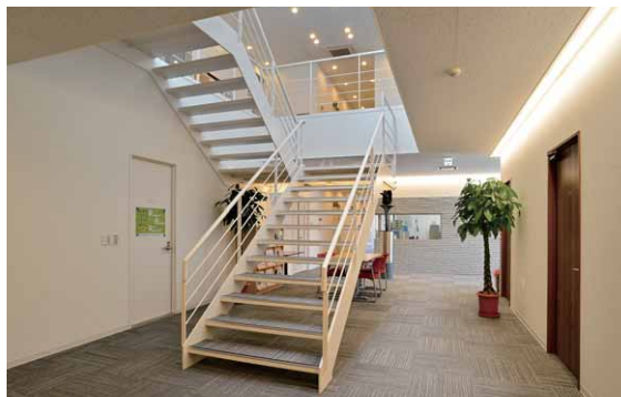
LEDの間接照明でソフトなあかり、LEDダウンライトの光で階段をサポート
