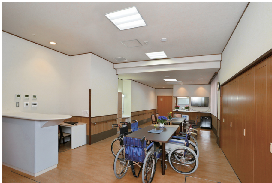
1日の陽射しのサイクルに合わせた光の色温度をプログラミングすることで、色温度の変化により時間経過のさりげない知覚を促す共同生活室の照明（写真は5000Kの色温度でさわやかな空間を演出）
