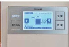
定置式家庭用蓄電システム対応のコントローラー
