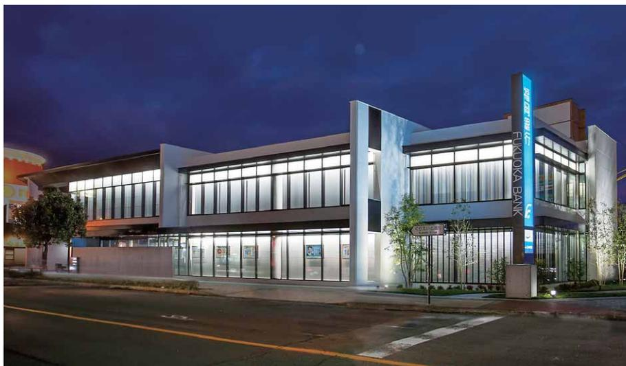
大型ガラス面に沿ってLEDライン器具を配置し、LEDの光で美しく浮かび上がらせた外観
