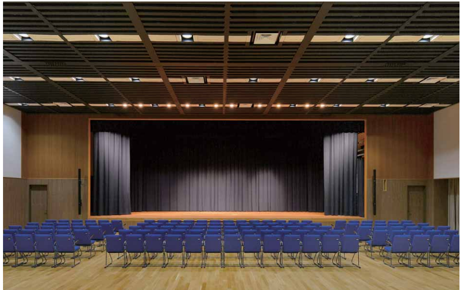
客席後方から望む多目的ホール。ホワイトラインの天井意匠にLED一体形ダウンライトを組み込み設置
