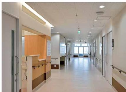
壁側に寄せて設置した病棟廊下のLEDダウンライト照明
