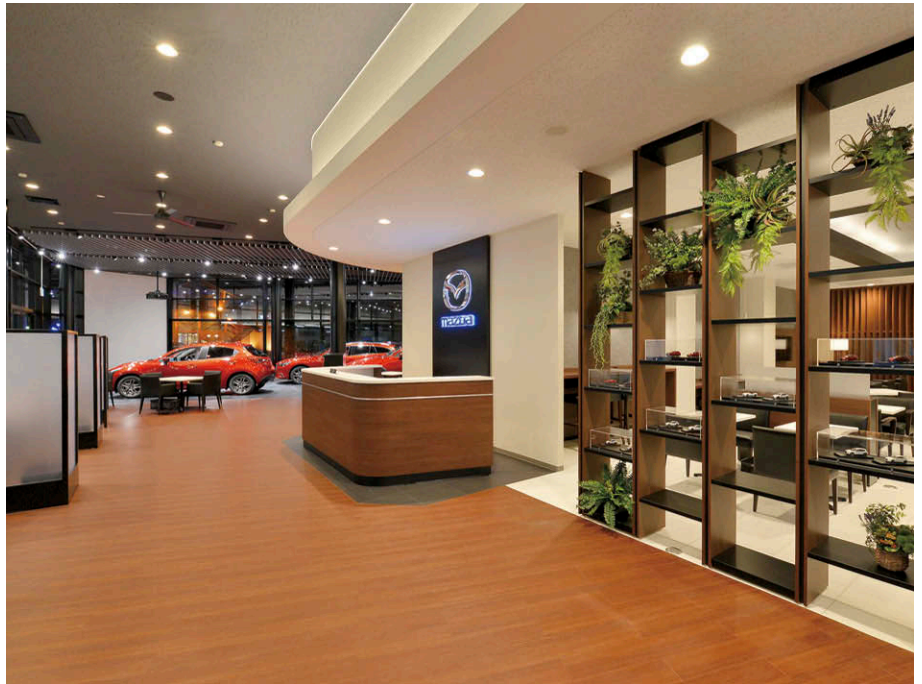
受付からショールーム方向を望む ベース照明は遮光角をとりグレアを抑制する銀色鏡面反射板を具備するLEDダウンライトを採用
