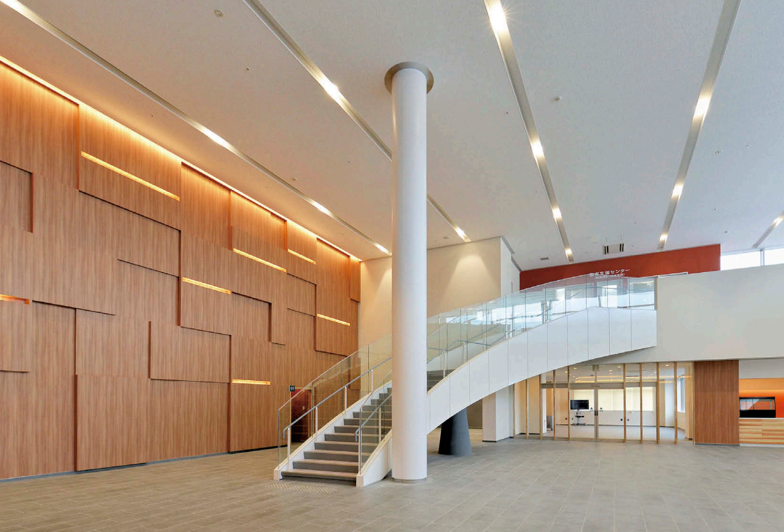
エントランスホールの照明 木を用いた正面の意匠壁は建築化照明、天井のスリット内にはLEDダウンライトを用い、患者の不安を軽減したやさしい雰囲気を出し創出
