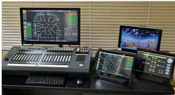
LEDスマートコンソール ベルトフェーダ卓の最新型調光操作卓(左)とワイヤレス操作器(右)
