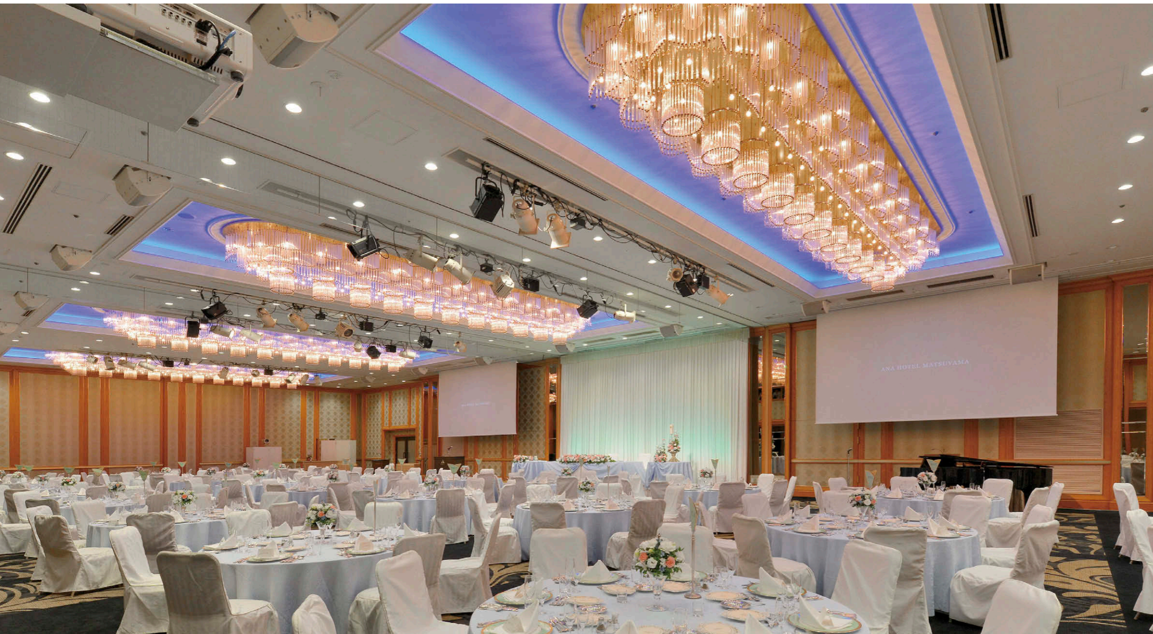
ダイヤモンドボールルーム（結婚披露宴の照明） LEDシアター用ダウンライト①をベース照明とし、折り上げ天井のフルカラーLED間接照明②により演出性を向上
