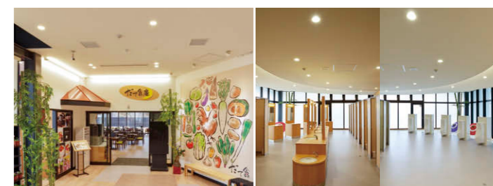
レストラン入り口の照明 2面配光間接光器具⑧を使用した光のアクセントにより遠目にも入り口がわかるよう設計演出 トイレの照明 (左：女子トイレ、右：男子トイレ) 「蔭」をイメージした円形空間にLEDダウンライト⑨を配置し「おもてなしの空間」を演出
