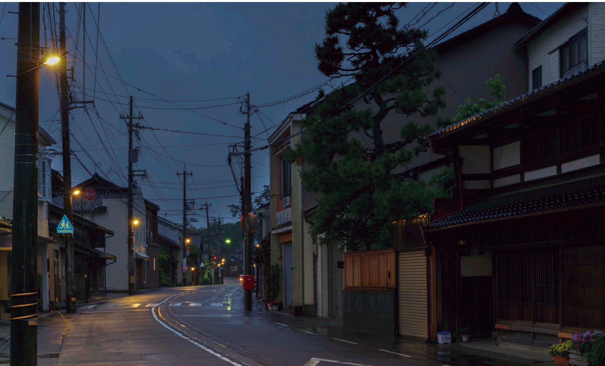
大野町4丁目の照明 本体色を「シティブラウン」に塗装処理したLED防犯灯耐塩形①を電柱に片側配置 昼間は歴史的景観に溶け込み、夜間は電球色の光で安全・安心な明るさを提供
