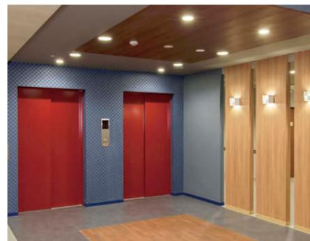
1階エレベーターホールのLEDユニット交換形ダウンライト①とLEDブラケット照明④による照明
