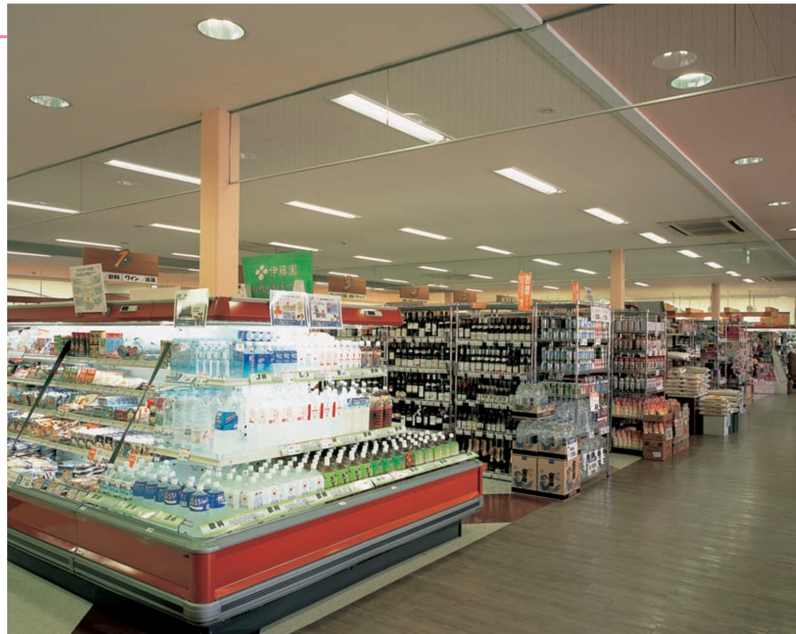
グロッサリーエリアの照明：ベース照明に105WHiコンパクト形蛍光灯ランプ1灯用埋込開放形器具を採用し、簡易照明制御システムSESL II あかりセンサで調光を可能にしている
