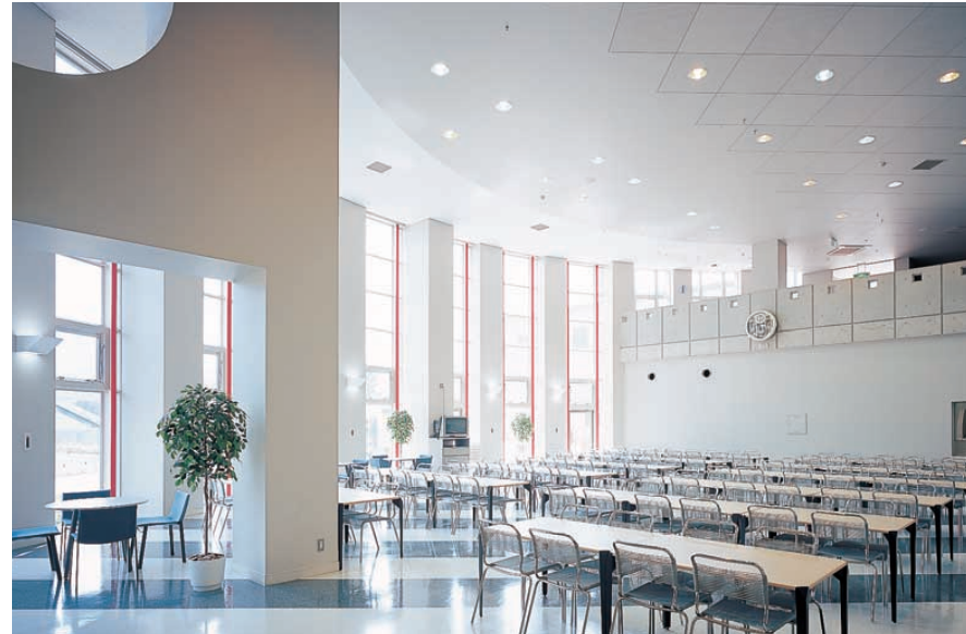
食堂 Dining hall 金属ハライドランプと高圧ナトリウムランプの埋込ダウンライトによる混光照明。2層吹抜けの大空間にうまく調和し、開放的な雰囲気を高めている
