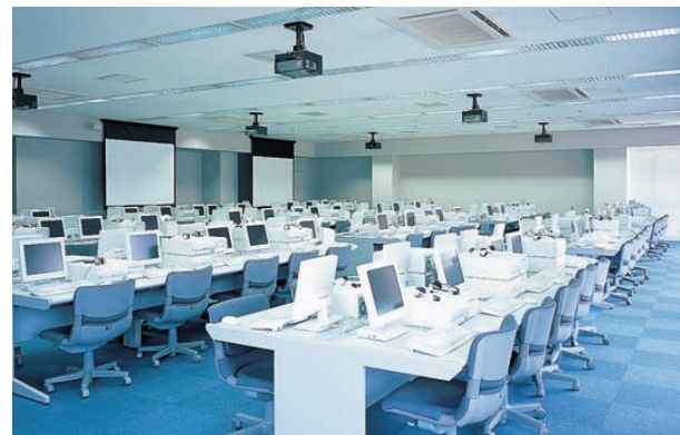
マルチメディア教室 Multimedia classroom 遮光角制御器具(OAソフト)を連結設置し、グレア防止をはかって、VDT画面を見やすく、快適な視環境が得られている
