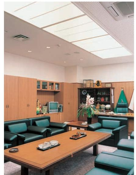
町長室：光天井風の効果を演出しているベース照明と周囲のダウンライトにより、高質で落ち着いた照明環境をつくり出している。
