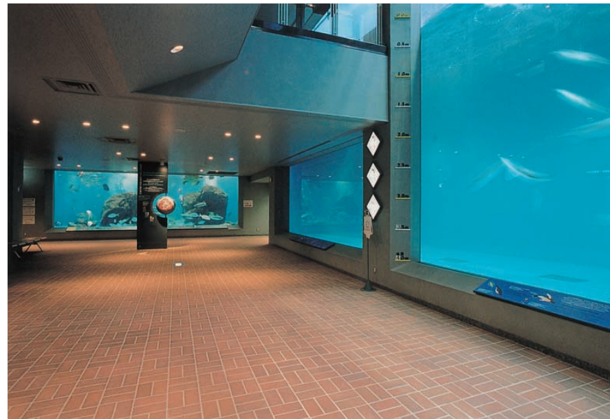
深さ4mの水槽と見学通路：通路の低い水平面照度と視線方向に高い鉛直面照度確保で、バランスの良い明暗効果を発揮
