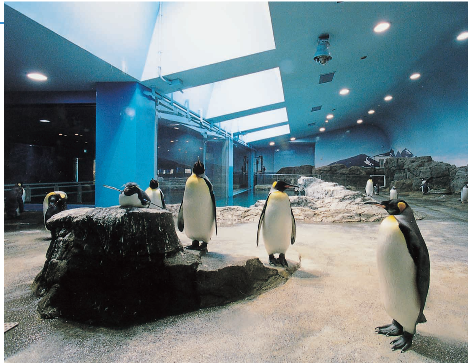
ペンギンプール 陸上部：トップライトからの採光とダウンライトによる人工照明をたくみに組み合わせている
