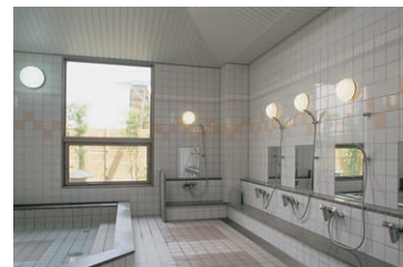
温浴施設：焼却熱を利用した温浴施設。30W形サークルライン1灯用防雨形器具を主照明に
