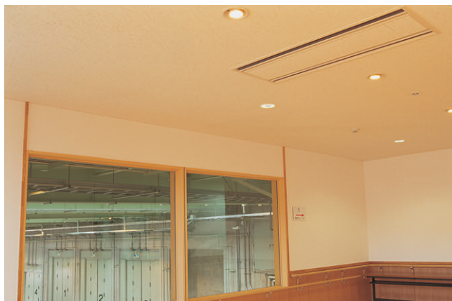
見学者ホールからプラットフォームを望む：木の素材感に調和するよう、ダウンライトには暖かみのあるコンパクト形蛍光灯電球色を使用
