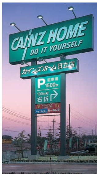
建看板照明：上部看板にはプレアサインを上側に3台設置し、鉛直面照度780lx、下部看板には上側に3台と下側に1台を設置。鉛直面平均照度は720lxを確保
