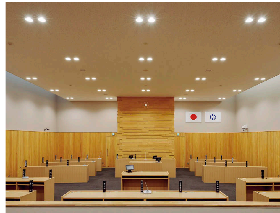
3階、議場のLEDユニット交換形ダウンライト⑤による照明。
