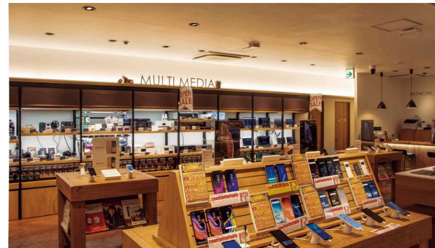
2階の売場は1階に比べて天井が低いため、照明器具の存在感を最小限に抑えるLEDユニバーサルダウンライト③④とLEDライン器具⑥を用いて、商品が目立つよう配慮している。
