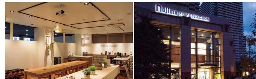
イベントスペースのLEDユニバーサルダウンライト③④⑤はイベント時の運用を考慮し、ゾーン毎の調光機能を有している。出入口付近には通路専用照明などを用いず、周辺環境への過剰な漏れ光を抑える用配慮している。
