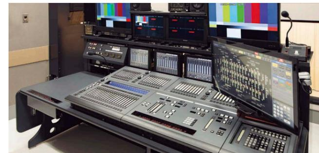
調光操作卓 MBS 仕様の調光操作卓⑦、右手前のタッチパネルに吊位置情報が表示され、より直感的な操作が可能。
