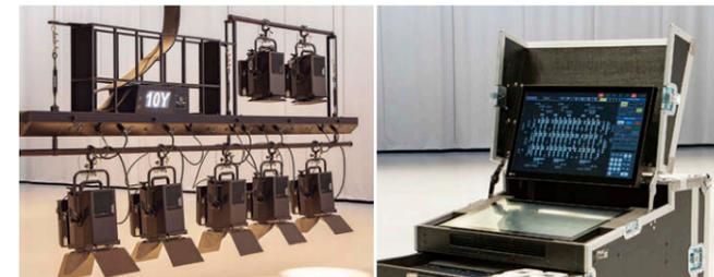
MBS特注バトン<sup>\*2</sup>に弊社特注 DMX/RDM ノードを装備 LED スポットライト①セット時。吊位置情報は調光操作卓へ自動で認識して表示。
