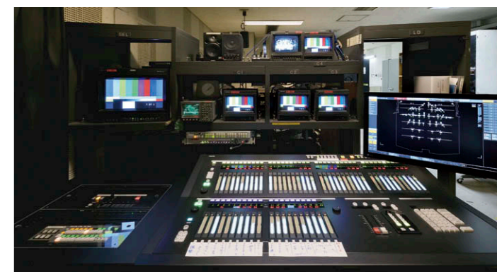
調光操作卓 ベルトエンコーダを備えた⑦ STV仕様の調光操作卓。自動認識された照明器具の吊り位置情報は右手パネルに表示。
