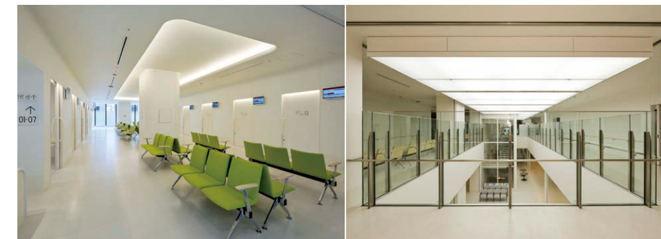
2階外来待合スペース LEDベースライト④で間接照明を計画。
