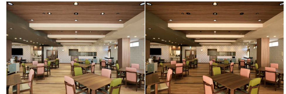
ダイニングルーム (左) 人が多い時間帯は高めの色温度(5000K)と高照度の光で室内を活気ある雰囲気演出⑥ (右) 低めの色温度(3000K)とやや低めの照度でくつろぎ感を演出⑨
