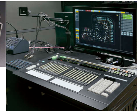
調光操作卓⑦ RDM 双方向通信により、LED 照明器具を自動認識。
