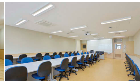
コンピュータ教室 目が疲れやすい授業内容を考慮してグレア抑制タイプのLEDベースライト⑥を採用。
