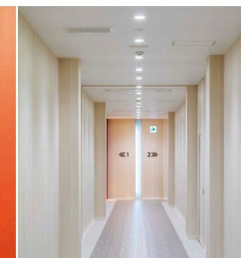
見学者通路 仕込み室の見学ゾーン(左)は電球色のLEDダウンライト⑤に加え、ユニバーサルダウンライト④を当てて赤い壁面を強調。東側通路には昼白色のLEDダウンライト⑥を均等配置。
