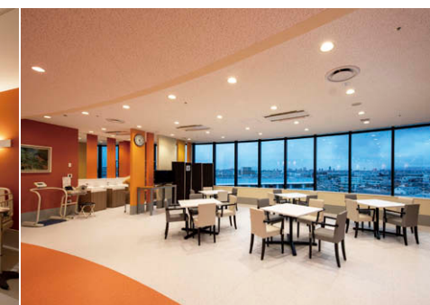
5階ラウンジ まぶしさを抑えるソフトグラデーションタイプのLEDダウンライト⑤を計31台設置。
