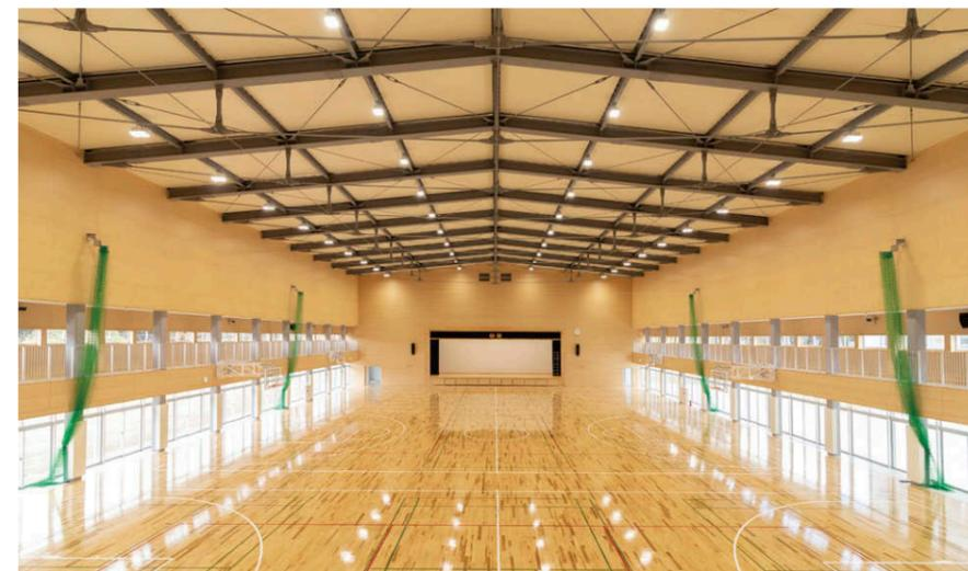
体育館 高さ12~13mに下面ガードを取り付けたまぶし軽減形のLED高天井器具を12台×4列、計48台配置。中央2列には18,600lmタイプ⑤を窓側には28,500lmタイプ⑥を採用。
