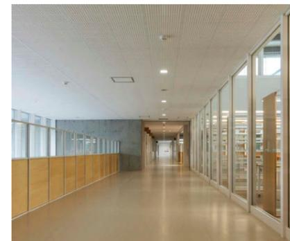
廊下 スクエアトーンの天井材に馴染む角形のLEDダウンライト②を4m弱の均等間隔で設置。
