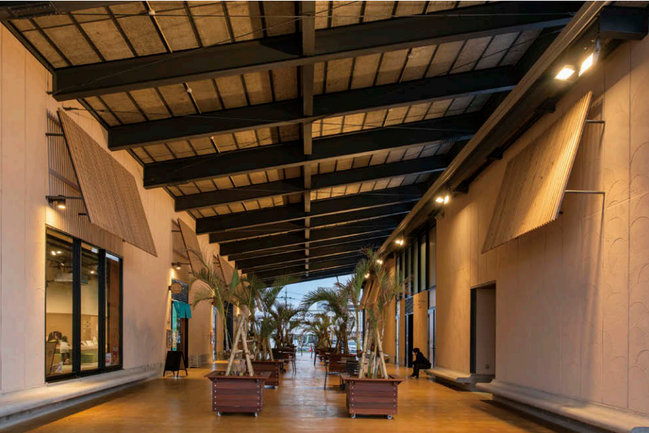
中央ピロティ（さわふじ広場） 大きな開口とすることで圧迫感の軽減を図ったピロティは、スペース全体が明るくなるように計 12 台の電球色 LED 小形投光器④（写真右壁）を採用。
