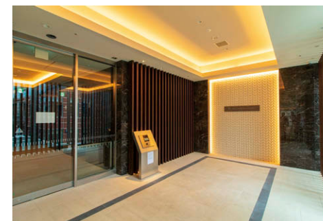
住居棟エントランス 屋内用LEDライン器具③による間接照明で高級感のある光空間を創出。
