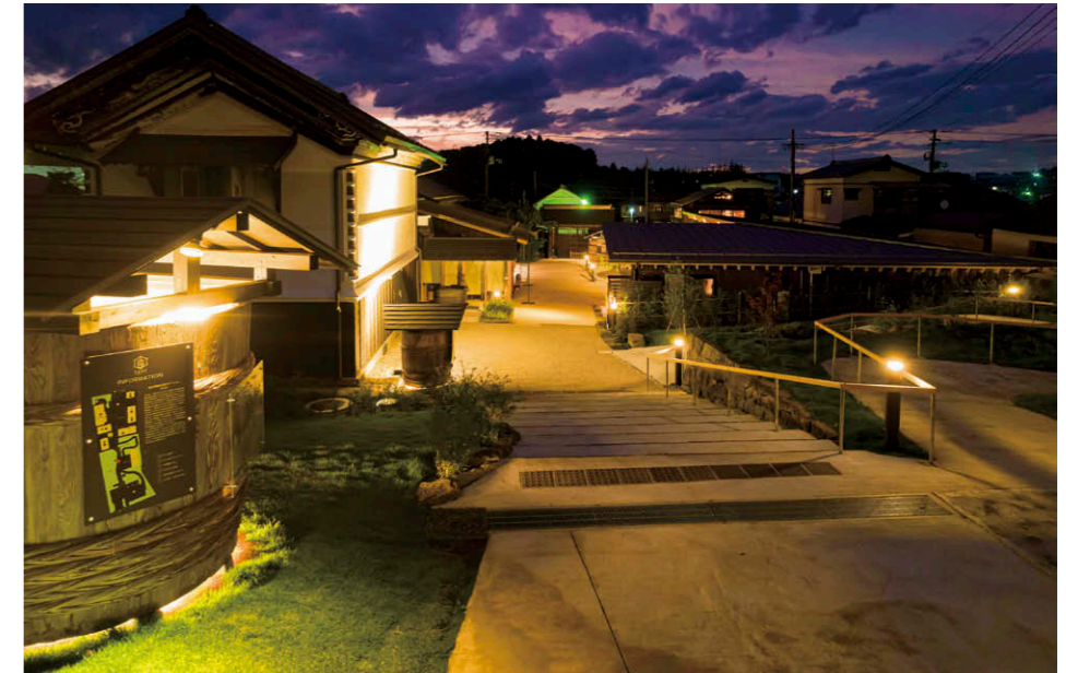
駐車場側から望む 蔵の外壁ライトアップには3000KのLED小形角形投光器③を採用。庭園遊歩道沿いに配置されたLEDガーデンライト②と共に宿場町の情景を演出。
