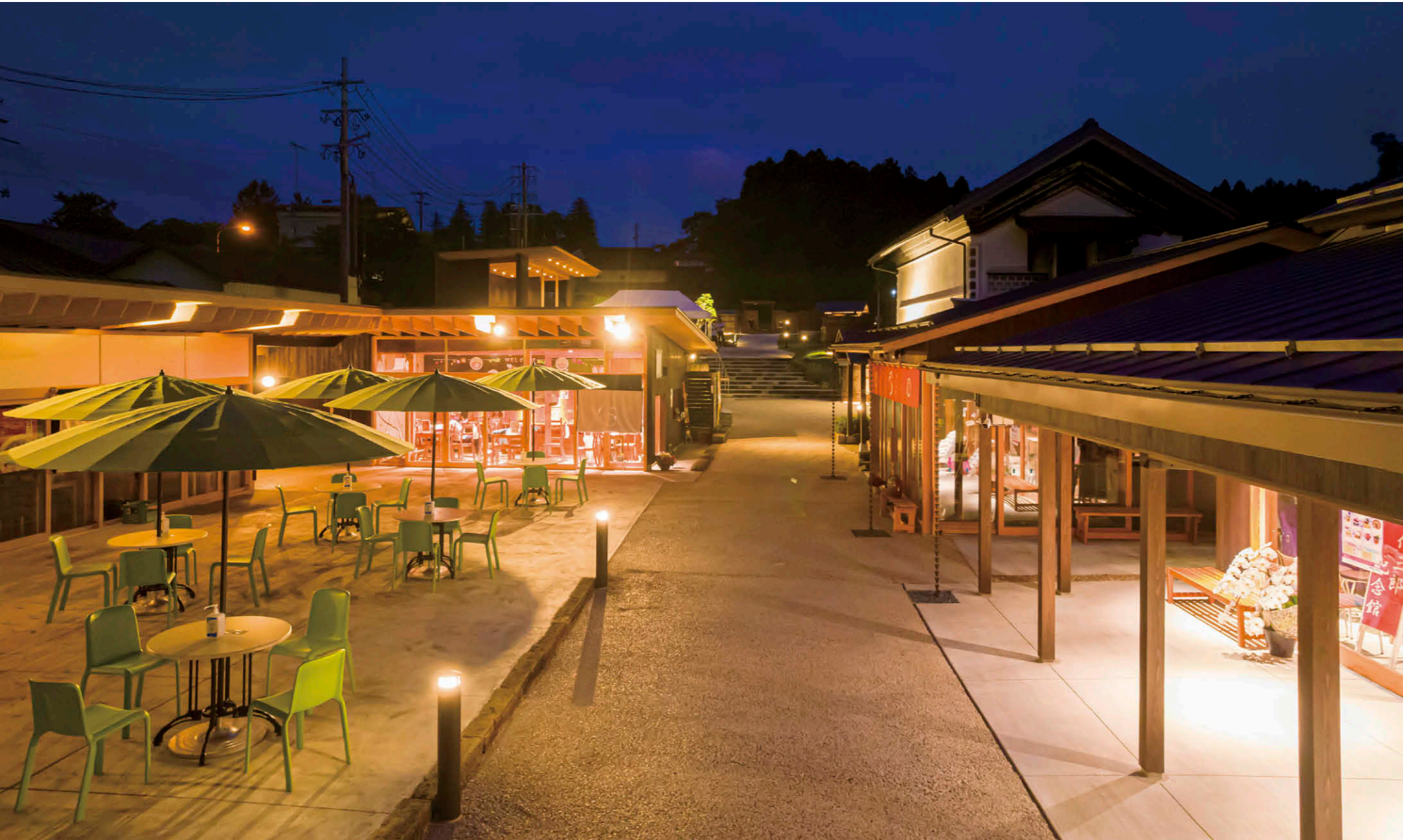
入口側から見た情景 奥へと続くLEDガーデンライト②が街道をイメージさせ、各建物の軒下に配置したLEDビームランプ形スポットライト①が賑わいを演出。
