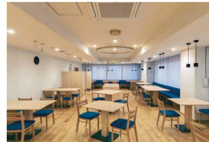
1階レストラン 調光タイプのLEDダウンライト②を、ベース照明として折り上げ天井を囲むように配灯。
