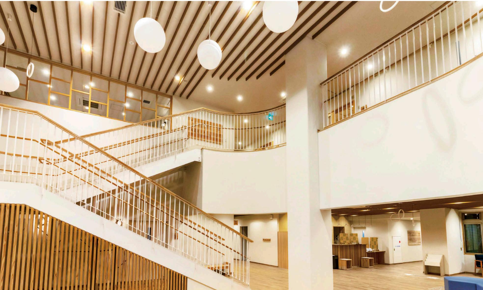
エントランスの照明風景 木製ルーバー天井部にはLED一体形ダウンライト①を計9台、2階廊下にはLEDユニット交換形ダウンライト②を21台設置。
