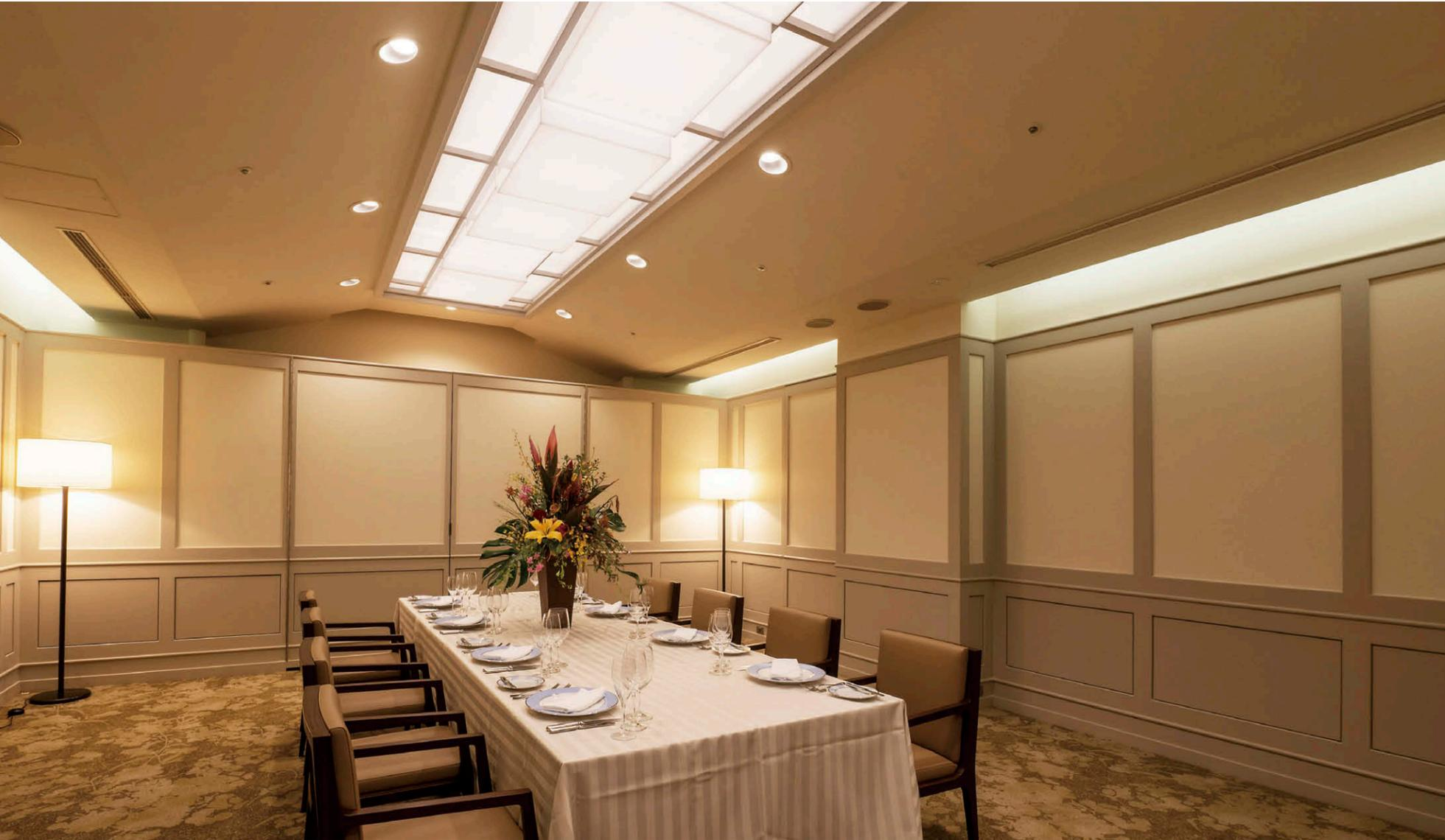
宴会場「アゼリア」中央に配置した光天井風の天井と間接光に TENQOO 直付調光形②を、その両側には LED 傾斜天井用ダウンライト①を設置。
